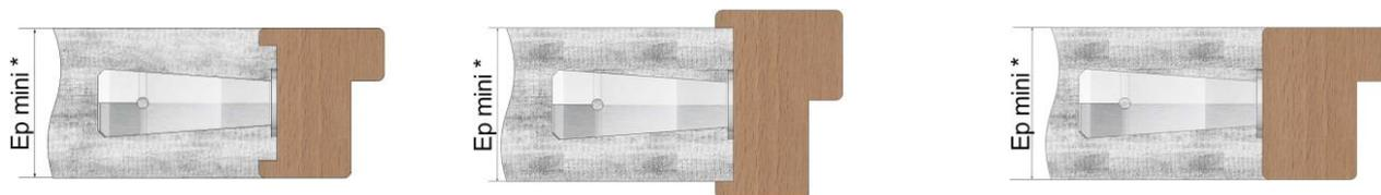
Possibilité de mettre des couvre-joints d'épaisseur mini **15mm** lorsque le châssis est affleurant à la paroi support.
