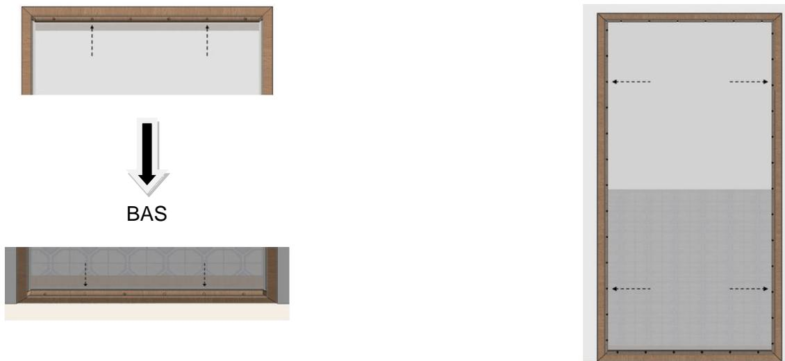
Bien pousser la parclose contre le verre afin de comprimer le joint de calage à  $\approx 2\text{mm}$  avant de mettre les fixations.
