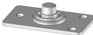
Encastrer et fixer la crapaudine dans le sol fini, avec son axe positionné à une côte A de 56mm (GRL100) ou 66mm (JANUS) par rapport à l'huissérie. Pour fixer la crapaudine, utilisez les chevilles et les vis fournies dans le sachet contenant la crapaudine ou des vis béton.
