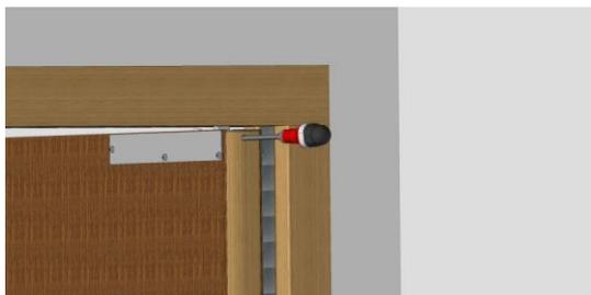
Pour réduire le jeu : visser la vis se trouvant dans le chant du vantail à l'aide d'un tournevis plat.
