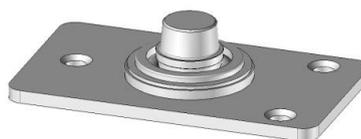
Encastrer et fixer la crapaudine dans le sol fini, avec son axe positionné à une côté A de 64mm (GRL 100) ou 70mm (JANUS) par rapport à la cloison. Pour fixer la crapaudine, utilisez les chevilles plastiques et les vis fournies dans le sachet contenant la crapaudine ou des vis béton.
