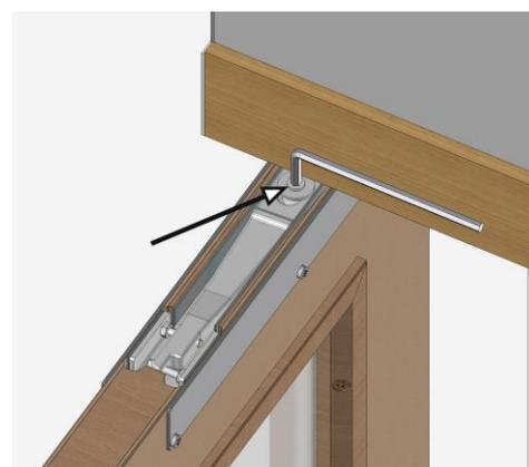
**Note** : Dans le cas d'une traverse de section > à 118 mm, dégondrer le vantail pour pouvoir accéder à la vis de blocage.
