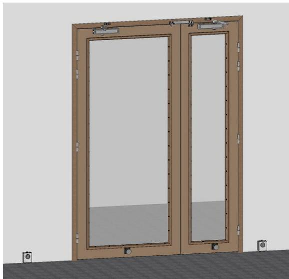
Ces distances de pose peuvent être ajustées au cas par cas afin que la commande manuelle intégrée de niveau d'accès zéro soit obtenue sous l'application d'un couple compris entre 40 et 120 Nm.
