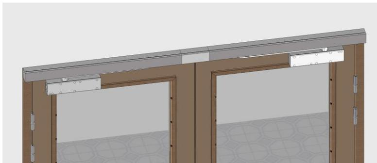
Veiller à ce que la force du ferme-porte corresponde à la largeur du vantail. Certains ferme-portes sont à force fixe et possèdent donc une plage de largeur correspondant à leur force. D'autres sont à force réglable et possèdent donc 2 voire 3 plages de largeurs possibles.
