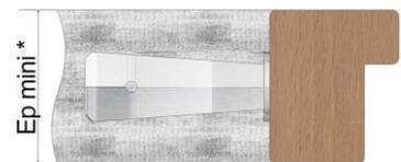
Possibilité de mettre des couvre-joints d'épaisseur mini **15mm** lorsque le châssis est affleurant à la paroi support.
