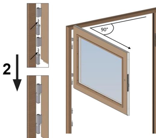
**7. Régler les jeux hauteur / largeur si nécessaire :**
