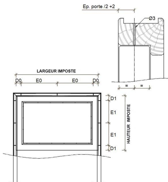
3. En tenant compte du jeu qui sera présent entre l'huissérie et l'imposte, percer les trous de fixation Ø3 au niveau de la rainure à brique à une distance du bord avant égale à l'épaisseur de la porte / 2 + 2mm en respectant la règle suivante :
