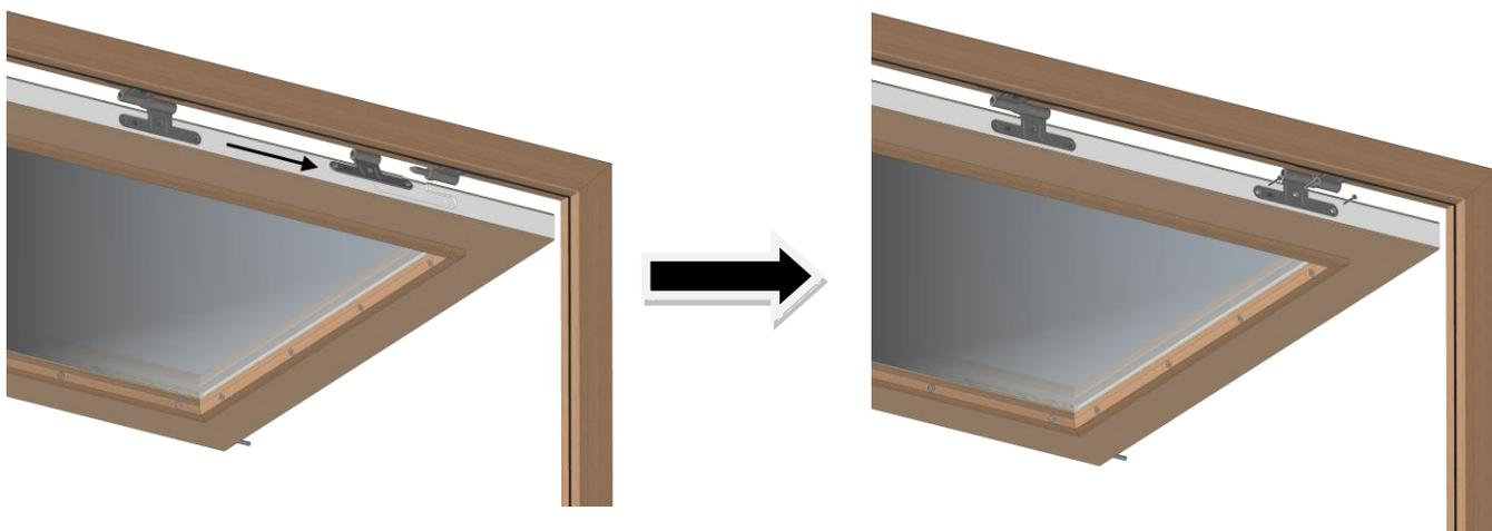
**7.** Régler les jeux hauteur / largeur si nécessaire :
