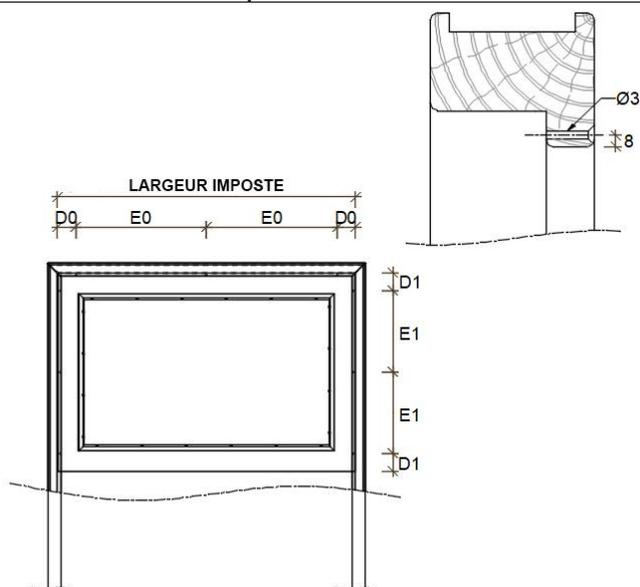
3. En tenant compte du jeu qui sera présent entre l'huissérie et l'imposte, percer les trous de fixation Ø3 au niveau du cochonnet à 8mm du bord en respectant la règle suivante :
