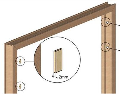
Dans le cas d'une huisserie acoustique, fixer provisoirement les cales sur le cochonnet en les laissant dépasser de 6mm à hauteur du joint isophonique
