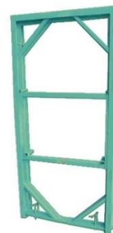
Note : Un mannequin de pose sera à positionner à l'intérieur de l'huissierie afin d'éviter son déplacement ou sa déformation lors du coulage du béton.
