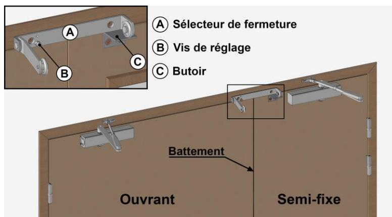
Positionner le butoir du sélecteur sur le semi-fixe pour que ce dernier fasse remonter la roulette du sélecteur lorsque le vantail semi-fixe se ferme et libère donc la fermeture de l'ouvrant.
