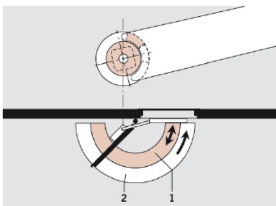
Dès ouverture du vantail, la fonction débrayée du ferme-porte est opérationnelle, soit à partir d'un angle d'ouverture  $>0^\circ$ . Cette fonction donne à la porte un grand confort d'usage sans aucune résistance à l'ouverture.
