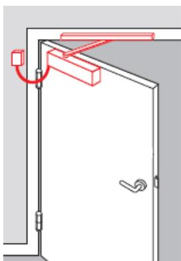
La glissière est fixée sur la traverse d'huisserie et le corps sur le vantail côté paumelles. Le système de débrayage étant dans le corps du ferme-porte, c'est ce dernier qui doit être alimenté. Un boîtier de branchement est donc fourni avec le câble faisant la liaison entre le boîtier et le ferme-porte.
