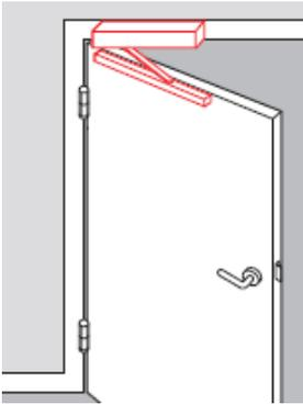
La glissière est fixée sur le vantail et le corps sur la traverse d' huisserie côté paumelles.
