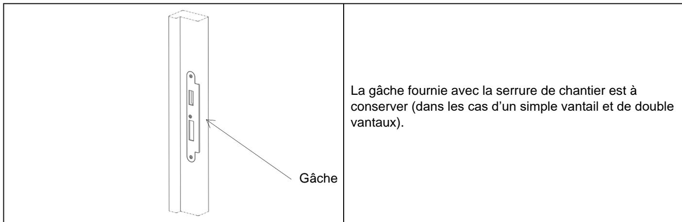
La gâche fournie avec la serrure de chantier est à conserver (dans les cas d'un simple vantail et de double vantaux).
