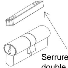
Serrure avec double fouillot suivant modèle
