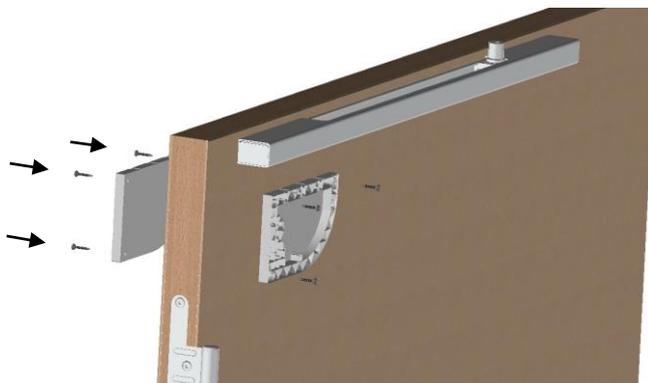
3. Percer un trou de Ø 14 mm à travers l'ensemble composé du vantail et des deux embases.
