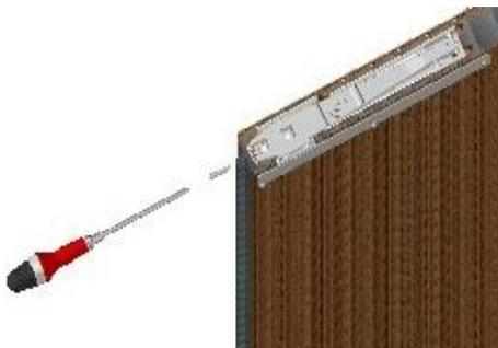
En premier lieu, insérer la vis de réglage du jeu latéral (dans le sachet avec la crapaudine) dans le chant du vantail au niveau de la penture haute à l'aide d'un tournevis plat (dans le cas du JANUS la vis de réglage du jeu latéral est déjà en place sur le bras du côté des vis de réglage de l'alignement, voir page 9).
