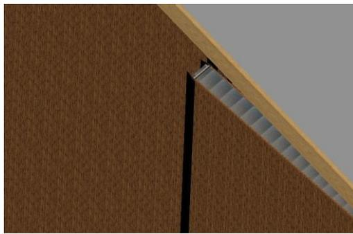
Pour régler ce jeu d'alignement, ouvrir la porte à 90° puis desserrer la vis de blocage de la penture haute avec une clé allen de 5 mm.
