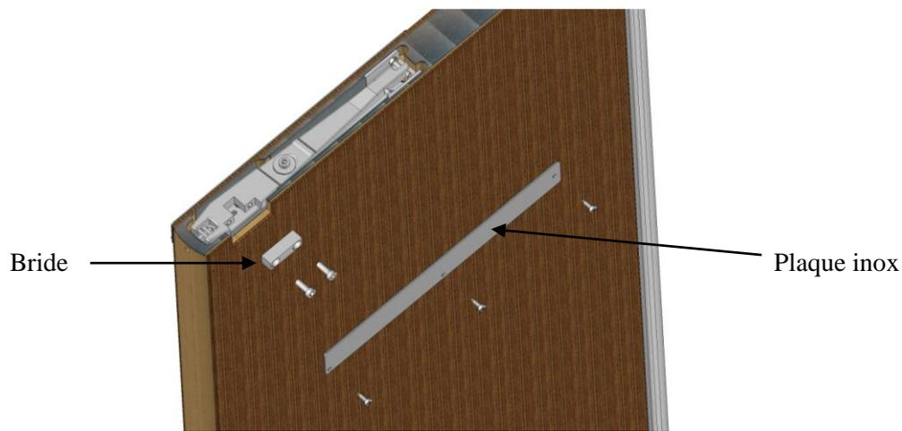
Positionner la porte parallèle à l'huissérie et à sa position finale, face recevant l'axe du pivot côté huisserie. Soulever là pour mettre en place la penture basse de la porte sur la crapaudine tout en inclinant le haut de cette dernière pour qu'il ne tape pas dans l'huissérie.
