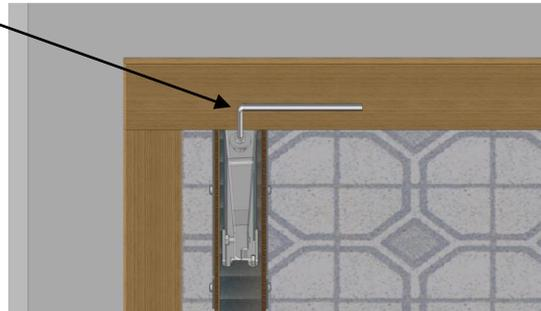
Pour la penture SEVAX, débloquer la vis de réglage du jeu latéral et ne pas oublier de la rebloquer une fois les réglages terminés.
