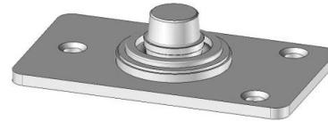
Encastrer et fixer la crapaudine dans le sol fini, avec son axe positionné à une côte A de 56mm (GRL 200 EMS) ou 66mm (LUCIFER) par rapport à l'huissérie. Pour fixer la crapaudine, utilisez les chevilles et les vis fournies dans le sachet contenant la crapaudine ou des vis béton.
