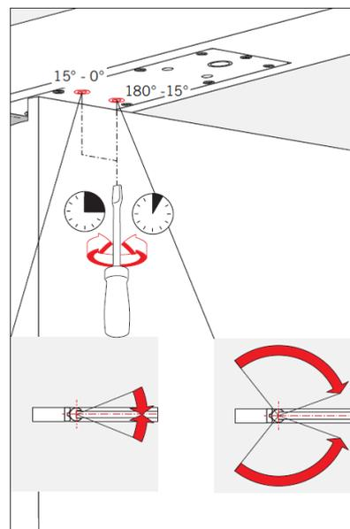
Pour le SEVAX JANUS, les vis 180° et 70° permettent d'agir sur la vitesse de fermeture suivant l'angle de la porte et la vis 15° permet d'agir sur l'à-coup final.
